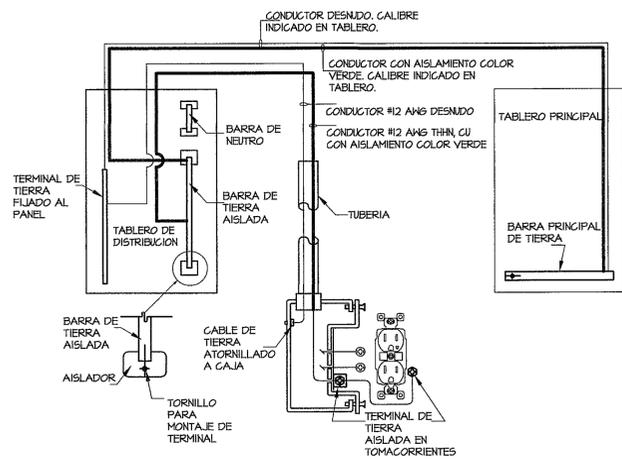
**DETALLE DE CONEXION PARA TOMACORRIENTES CON TIERRA AISLADA**
