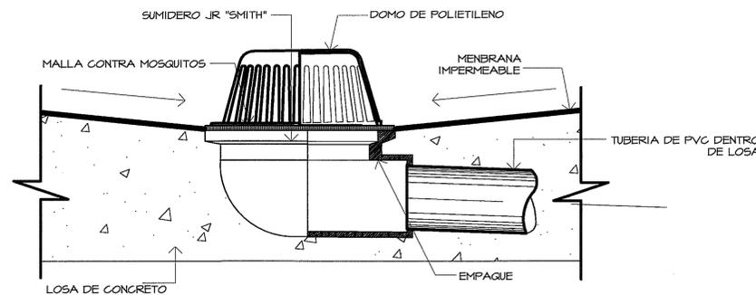
**DETALLE DE INSTALACION DE DRENAJE EN LOSA DE CONCRETO**
