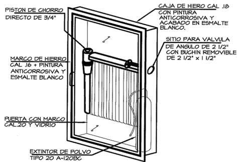
\* SERAN SIMILAR AL FABRICADO POR GUARDIAN FIRE 1600 SERIE EQUIPMENT, CO. CON EXTINTOR DE INCENDIO INCORPORADO. LAS MANGUERAS SERAN DE 100 PIES DE LARGO
